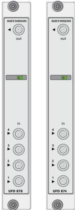
Die UFOcompact plus-Module UFO 878/874 sind 8fach, bzw. 4fach DVB-S/-S2 auf DVB-C-Transmodulatoren. Beide Geräte besitzen jeweils 4 DVB-S/-S2-Eingangsbuchsen mit der Möglichkeit DiSEqC™-fähige LNBs und Eingangsmatrizen anzusteuern, sowie eine Ausgangsbuchse zur Einspeisung der transmodulierten Datenströme in ein Kabelnetz.
