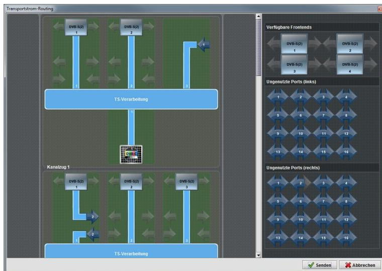
Abb. 98: Transportstrom-Routing-Ansicht von Modulen mit Multiplex-Funktionalität
